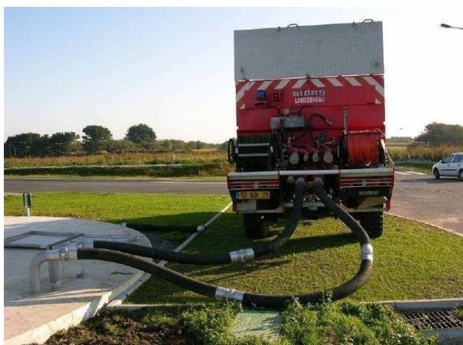
Dispositif de mise en aspiration sur une réserve enterrée de  $240 \text{ m}^3$  avec 2 sorties de  $\varnothing$  100 mm. Chaque sortie étant sur une canalisation de  $\varnothing$  100 mm.
